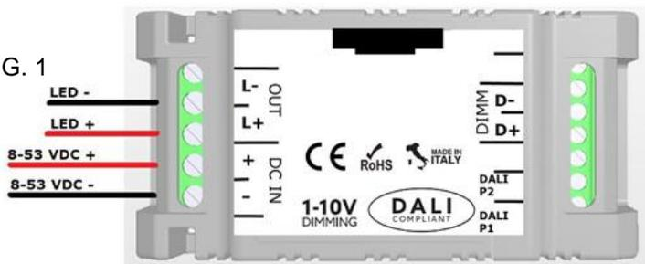
Il dimmer NTG401 deve essere alimentato secondo la polarità indicata in FIG. 1 attraverso i morsetti DC IN (+ e -). Nel caso in cui la polarità di alimentazione venga invertita il dispositivo non subisce nessun danno. Il LED (LED PWR) presente a bordo scheda segnala la presenza di alimentazione.
