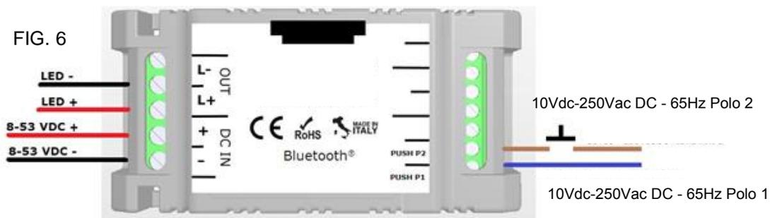
Al fine di attivare tale modalità di controllo/funzionamento è necessario installare l'app sul dispositivo Android o iOS che si vuole utilizzare per il controllo del dimmer NTG400 e disconnettere gli eventuali ingressi 0-10V (1-10V) o potenziometro connessi al dimmer.
