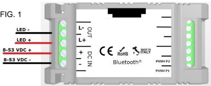
Il dimmer NTG400 deve essere alimentato secondo la polarità indicata in FIG. 1 attraverso i morsetti DC IN (+ e -). Nel caso in cui la polarità di alimentazione venga invertita il dispositivo non subisce nessun danno. Il LED (LED PWR) presente a bordo scheda segnala la presenza di alimentazione. Il LED (LED DIM) indica lo stato di dimming dell'uscita. La connessione del carico LED deve essere effettuata utilizzando i morsetti OUT (L+ e L-).
