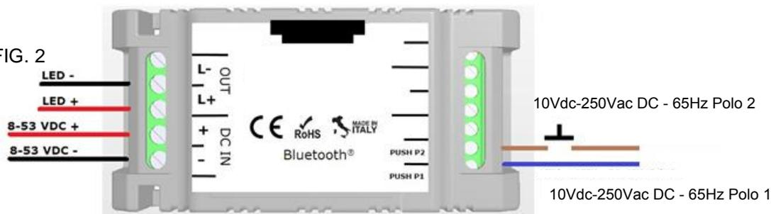
Al fine di attivare tale modalità di controllo/funzionamento è necessario rimuovere eventuali segnali di controllo dagli ingressi D+ e D- e connettere tra gli ingressi DALI/P1 e DALI/P2 un segnale in tensione continua o alternata (range di tensione DC: 10÷265V, AC 12÷ 265Vac 50÷65Hz) interrotto da un pulsante normalmente aperto (N.O.). Il segnale di ingresso non necessita di polarizzazione.
