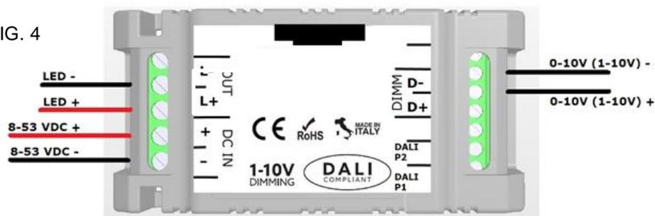
Al fine di attivare tale modalità di controllo/funzionamento è sufficiente connettere il segnale 0-10V/1-10V di controllo tra l'ingresso D+ e D- (facendo attenzione a rispettare la corretta polarità) e disconnettere i restanti segnali di controllo.
