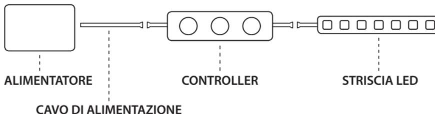
1. Collegare il cavo di alimentazione al controller (lato **⊕5-24V⊖**) tramite apposito connettore.
