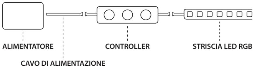
1. Collegare il cavo di alimentazione al controller (lato
